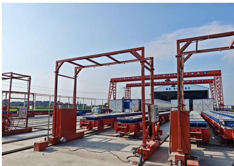
图 5.7-4 自行式门架喷淋设备
